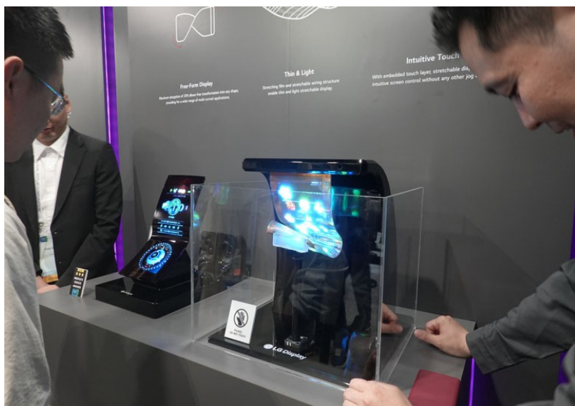
図表3-1-1 LG ディスプレイのフルカラーかつ伸縮可能なマイクロ LED ディスプレイ
